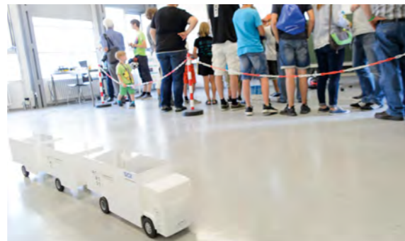
Autonom einparken - mit mehreren Anhängern!? Das geht! Dieser Truck verfügt über ein Einpark-Assistenzsystem zum automatischen Manövrieren - entwickelt im Institut für Systemdynamik.
