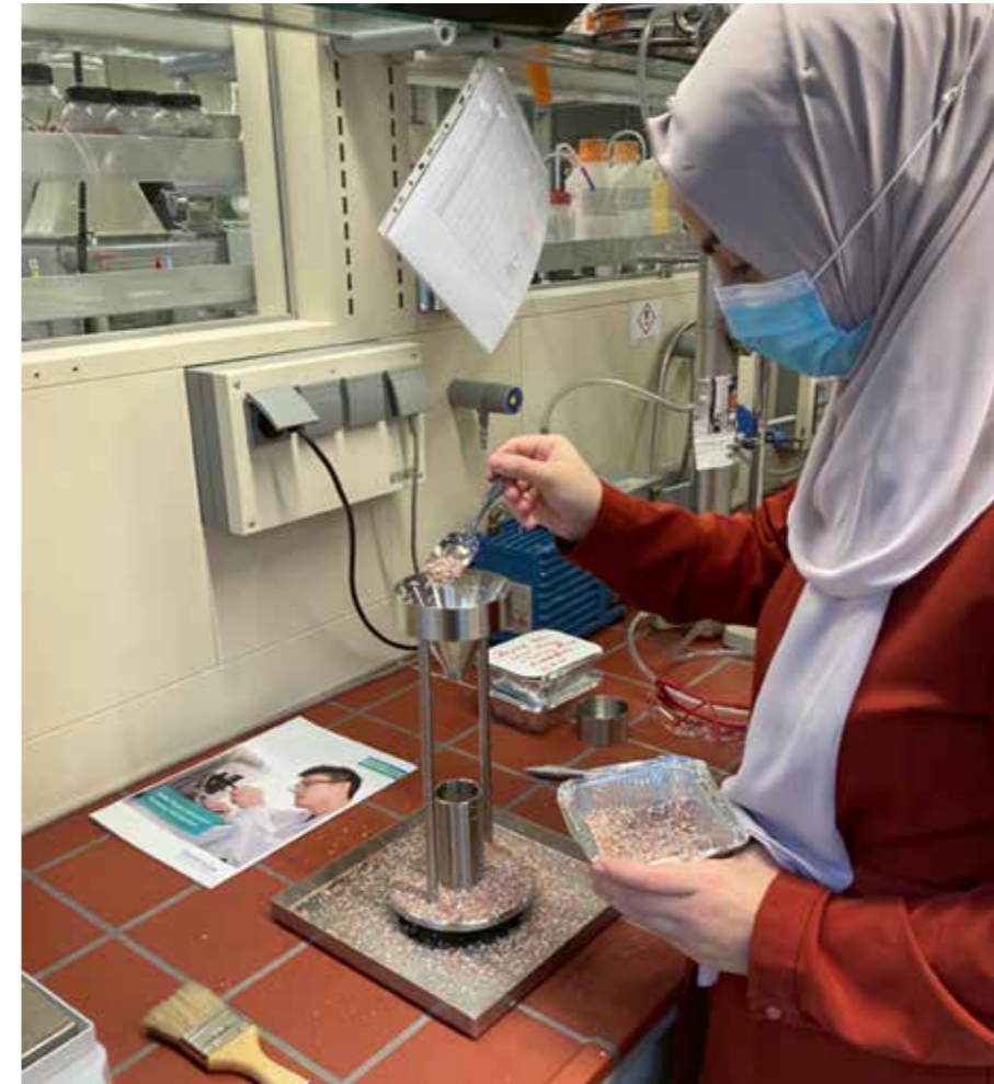
Masterstudentin Zeynep Ekici bei der Schüttdichtebestimmung mit Hilfe des Be-Densi B1, den die Firma Battersize dem Labor für Partikeltechnologie & Sortiertechnik zur Verfügung gestellt hat.
